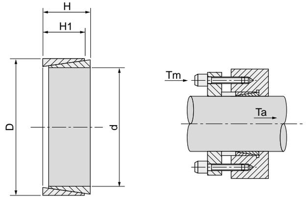
esempio di montaggio / example of assembly
